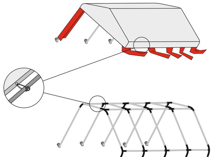
4. Nun kann die zweite Seite des Daches aufgerichtet werden. Benutzen Sie die Heringe (Pos. 10) um die Fussstangen im Boden zu fixieren. Die Fussstangenabdeckungen sind mit den Haken (Pos. 12) in die dafür vorgesehenen Löcher einzuhängen.
