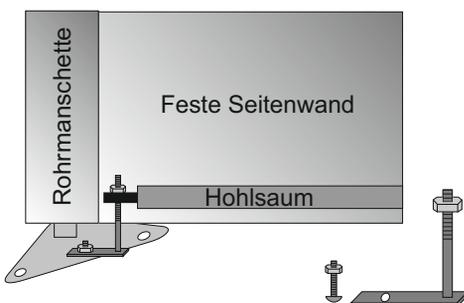
Die feste Seitenwand wird bei der Seitentraverse eingehängt. Bei der Fussbasis muss der Winkel montiert und die Niederhaltstange in den Hohlsaum eingeführt werden.
