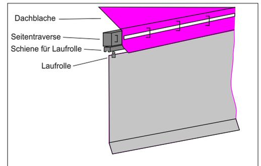
Alle schiebbaren Seitenwände werden mit stabilen Vorhangschiene fix unterhalb der Traverse verschraubt. Laufrollen mit Kugellager für mühelose Bedienung.
