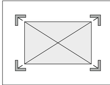
Beim Positionieren der Eckwinkel darauf achten, dass die Firsttraversen auf einer Linie zueinander stehen
