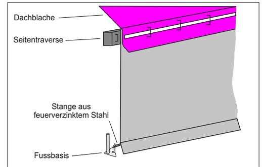
Schiebbare Seitenwand Material in PVC schwer brennbar B1
