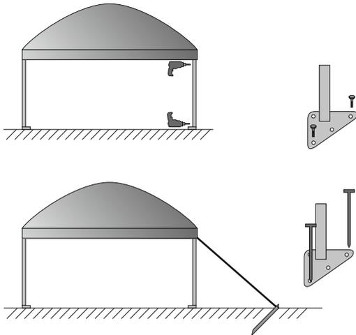
Falls das Zelt mit dem Boden verschraubt wird, muss die Fussbasis sowie der Eckwinkel mit dem Fussrohr verschraubt werden.
